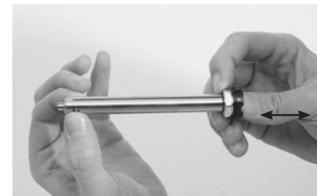
Funktion des Kugelsperrbolzens überprüfen. (Druckknopf ein- und austrasten). Den Kugelsperrbolzen zur Vormontage in die Radnabe einführen.
