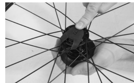
Gummikappe schliessen und Rad links und rechts am Anhänger montieren.
