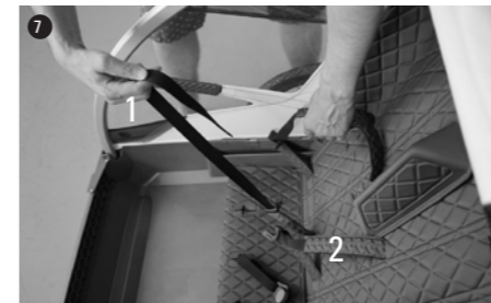
Dazu die beiden mittleren Schultergurte vollständig aus der Rückenlehne ausfädeln wie bei Gurt 1 gezeigt.
