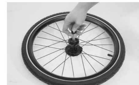
Funktion des Kugelsperrbolzens überprüfen. (Druckknopf ein- und austrasten). Den Kugelsperrbolzen zur Vormontage in die Radnabe einführen.
