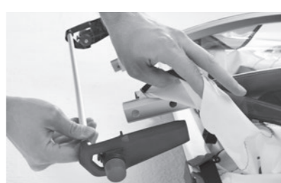
Beide Kunststoffteile links und rechts in die dafür vorgesehenen Bohrungen einsetzen.
