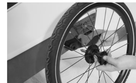
Gummikappe schliessen und Rad links und rechts am Anhänger montieren.
