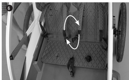
Beide inneren Gurtschnallen müssen vertauscht montiert werden
