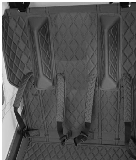
Beide inneren Gurtschnallen müssen vertauscht montiert werden
