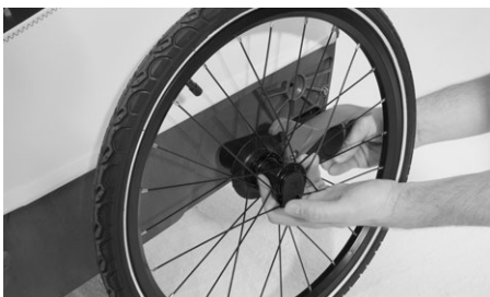
Gummikappe schliessen und Rad links und rechts am Amhänger montieren.
