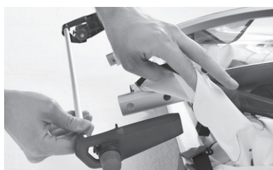
Beide Kunststoffteile links und rechts in die dafür vorgesehenen Bohrungen einsetzen.
