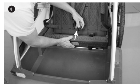
Durch die mittlere Öffnung wird er wieder nach oben gezogen
