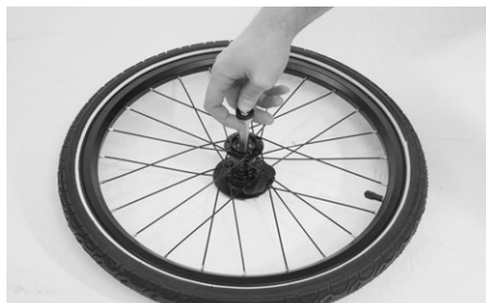
Funktion des Kugelsperbolzens überprüfen. (Druckknopf ein- und austrasten). Den Kugelsperbolzen zur Vormontage in die Radnabe einführen.
