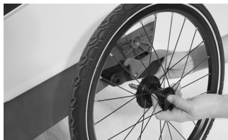
Gummikappe schliessen und Rad links und rechts am Amhänger montieren.
